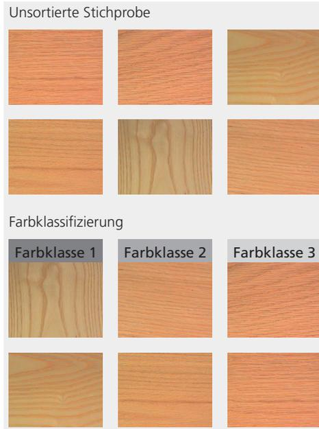
Die Abbildung stellt eine typische Anwendung des FOQUS-Systems dar: Oben ist die unsortierte Stichprobe zu sehen, unten dieselbe Stichprobe nach der Sortierung durch FOQUS.
