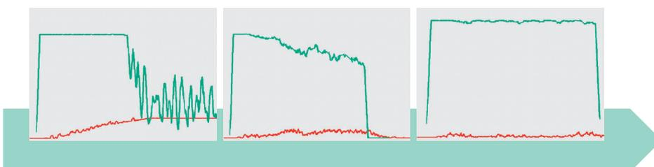
Simulationsläufe für ein Kommissioniersystem auf der Basis verschiedener Optimierungsstrategien mit dem Ziel, einen möglichst gleichmäßigen Ausstoß (obere Kurven) und eine geringe Anzahl von »Irrläufern« innerhalb eines Zeitabschnitts zu erhalten.
