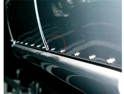
Auf der lackierten Oberfläche eine Delle erkennbar (Spiegelung). Solche Dellen sind auf dem unlackierten Bauteil meist nicht sichtbar und können nur von Experten ertastet werden. Auf lackierten Teilen sind solche Fehler leicht zu sehen, aber sehr viel kostenaufwändiger zu entfernen.
