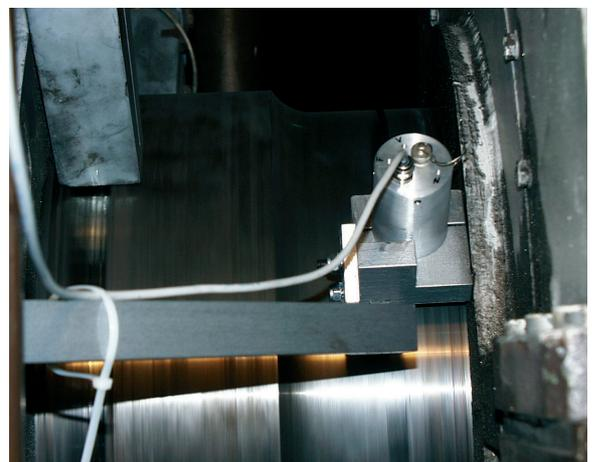
Zur Zeit wird TorAn im Kraftwerk Bergkamen (Luftaufnahme oben) getestet. Der berührungslose Sensor (unten) misst direkt an der Welle die Torsionsschwingungen eines 747 MW Turbosatzes (mit freundlicher Unterstützung der elektrotechnischen Abteilung des Steag und RWE Power Kraftwerks Bergkamen).
